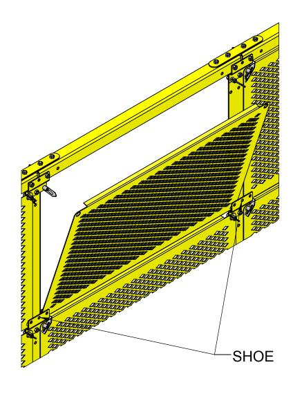
PULL THE TOP PART OF THE PANEL TOWARDS YOU SO THE PANEL SLIDES OFF THE OPEN WEDGE-LOCKS AND RESTS ON THE SHOES. THE PANEL MAY NOW BE LIFTED OFF THE SHOES AND SET OFF TO THE SIDE TO MAKE WAY FOR MAINTENENCE ON THE GUARDED EQUIPMENT.
